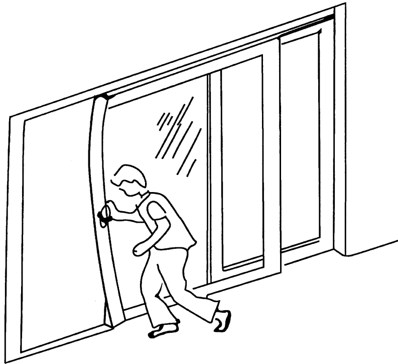
图 1 扭曲试验状态图
