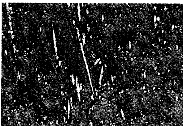
图4 隔热条横向玻璃纤维分布典型图示
